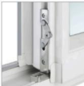
Verrouillage automatique du vantail secondaire à la fermeture du vantail principal. À l'ouverture du vantail principal, le vantail secondaire est maintenu en position fermée par l'intermédiaire d'un point escamotable.
