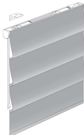
Pans sur mesure retenus entre 200 et 250 mm\* selon hauteur du store, afin que ces pans aient des hauteurs uniformes et qu'une fois replié le tissu côté intérieur soit toujours protégé du soleil. Le dernier pan est toujours tendu.
