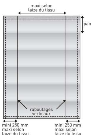
En fonction des laizes des tissus, à partir d'une certaine largeur, nous assemblons le tissu en 3 laizes en les raboutant verticalement en optimisant toujours l'emploi de la plus grande laize au centre et en ayant de part et d'autre des bandes raboutées de largeur mini de 250 mm.
